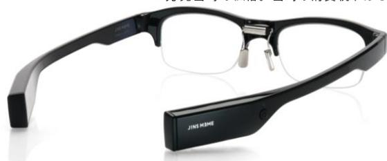
眼電位センサーはノーズパッド周りに、6軸モーションセンサーは片方のテンプルエンドに。バッテリーはもう一方のテンプルエンドに分散して搭載。装着性に課題があった。
